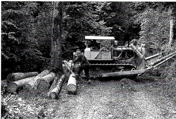
Dove il terreno è più accidentato l'esbosco avviene con mezzi a cavo operati da macchine che stazionano su di una strada preesistente. Piuttosto che costruire nuove strade, si rinuncia ai tagli culturali (foto ex-A.S.F.D.).
