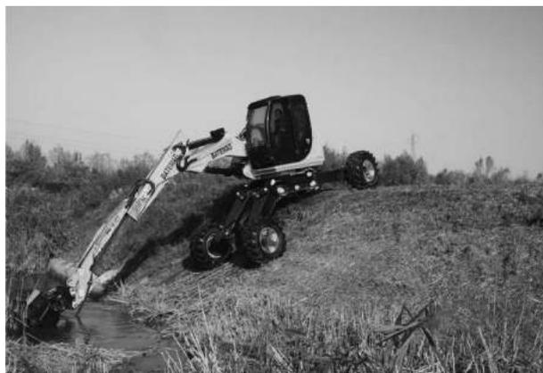
Fig. 9 – “Ragno” per gli interventi di espurgo e di riduzione della vegetazione acquatica spondale.
