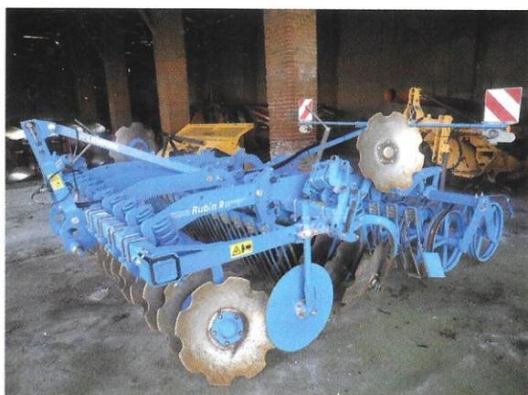
Fig. 3 – Erpice a dischi con rulli utilizzato prima della sommersione delle risaie.
