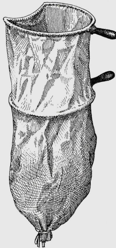
Fig. 6 - Un vaglio; in corrispondenza del manico inferiore vi è una fina rete metallica.
