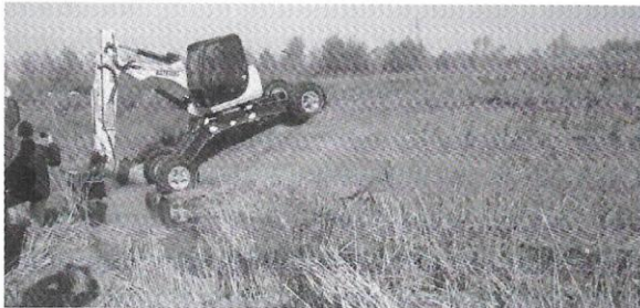
Fig. 14 – Questo mezzo meccanico permette una forte flessibilità in termini di spostamenti lungo e all'interno del canale. Nella foto, il ragno è sceso da un argine per posizionarsi a ridosso dell'alveo bagnato. (Foto Bruno Boz).
