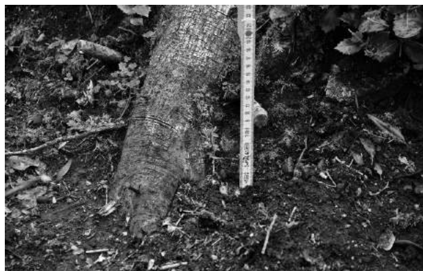
Fig. 8 – Rilevamento del materiale terroso asportato, 27/02/2016, ore 11:39. I chiodi e la traccia indicano la successione degli eventi erosivi. Località S'Isteri.
