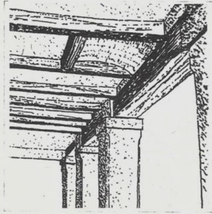
Fig. 14. Volta in mattoni, isolante, posta sotto il camino, sostenuta da una struttura lignea a cui si appoggia anche il sottofondo stesso del camino (il rialzo del focolare).
