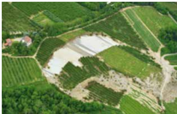
Fig. 14 – La frana dell’Agriturismo Le Siepi di San Giovanni del maggio 2023 a poca distanza da Fontanelice, ma in Comune di Borgo Tossignano, nella parte superiore della Marnoso Arenacea. Il sottile suolo solidale su alcuni strati arenacei giallastri è scivolato nell’insieme prima in blocco poi disarticolandosi in vari pezzi su uno strato argilloso grigio. È evidente la traslazione con parziale rotazione e accumulo caotico alla base dei e fra i blocchi di vigneto. La nicchia di distacco è abbastanza lineare, diretta circa NV-SE interrotta da una frattura trasversale circa SW-NE.
