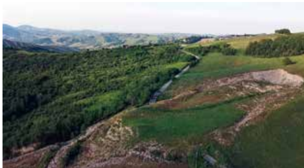
Fig. 16 – Frana traslativa lungo strato Arenacea dello spessore di una decina di m nella parte superiore della Marnoso Arenacea, che ha sepolto la strada verso Giugnola.
