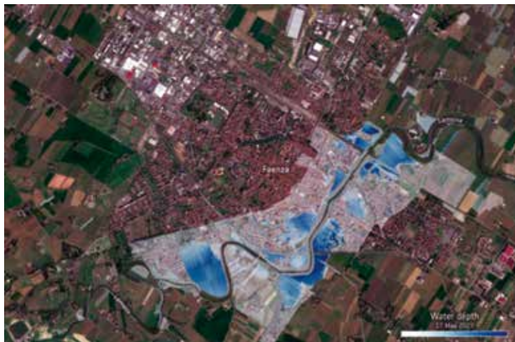
Fig. 10 – Altezza massima dell'acqua sul suolo raggiunta dall'alluvione a Faenza a fine maggio 2023 (ESA). Si noti che l'alluvione ha raggiunto il pieno centro storico e non solo il Borgo oltre Lamone.
