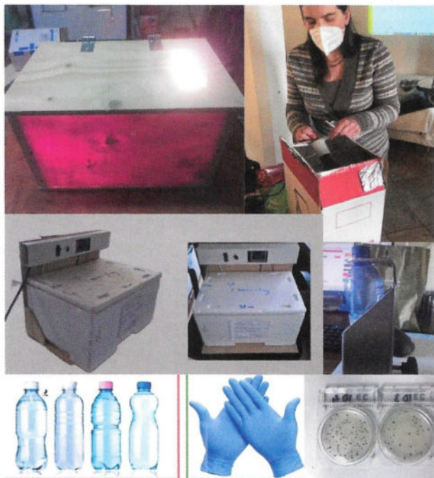
Fig. 2 – Esempio degli strumenti che compongono il kit per il monitoraggio dell' E. coli . In alto sono presenti tre diversi prototipi di incubatore. In basso le piastre Compact Dry dell'HyServe per le colture dell' E. coli .
