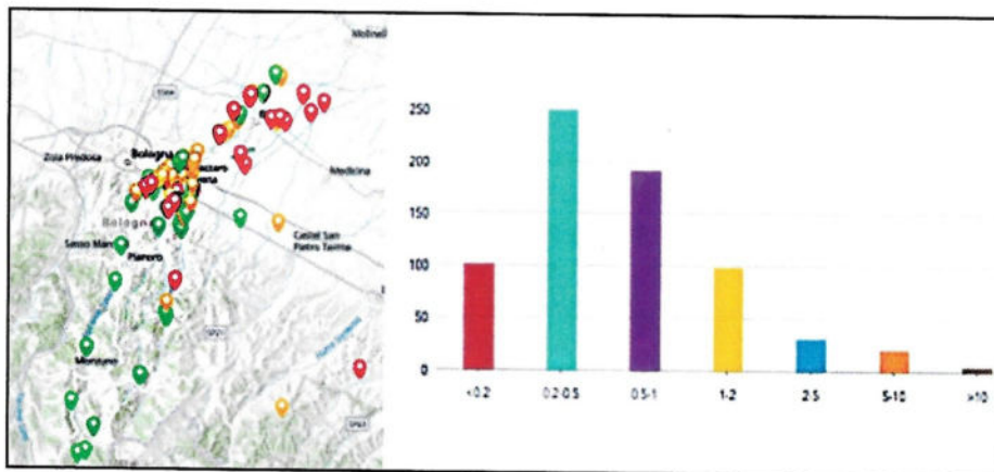
Fig. 1 – A dx mappa dei siti di campionamento, nel bacino dell'Idice, con un riferimento qualitativo riferito al colore (rosso = scarsa; giallo = moderata; verde = buona). A sx numero di campioni, in ascissa, i cui valori di nitrati \text{NO}_3 in mg/l sono risultati compresi nei 7 intervalli riportati in ordinata.
